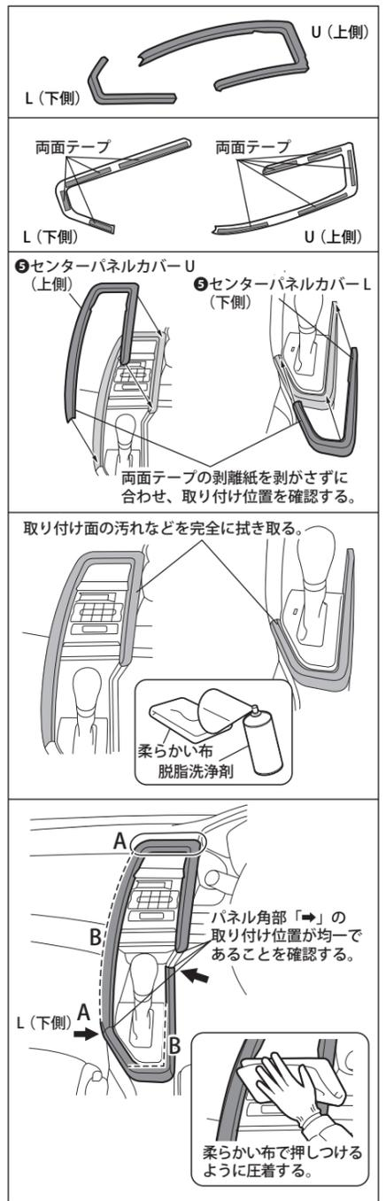
1. 両面テープの剥離紙を剥がさずに、センターパネルカバーを車両側に合わせ、取り付け位置を確認します。
