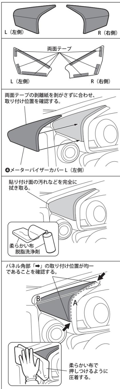
1. 両面テープの剥離紙を剥がさずに、メーターバイザーカバーを車両側に合わせ、取り付け位置を確認します。
