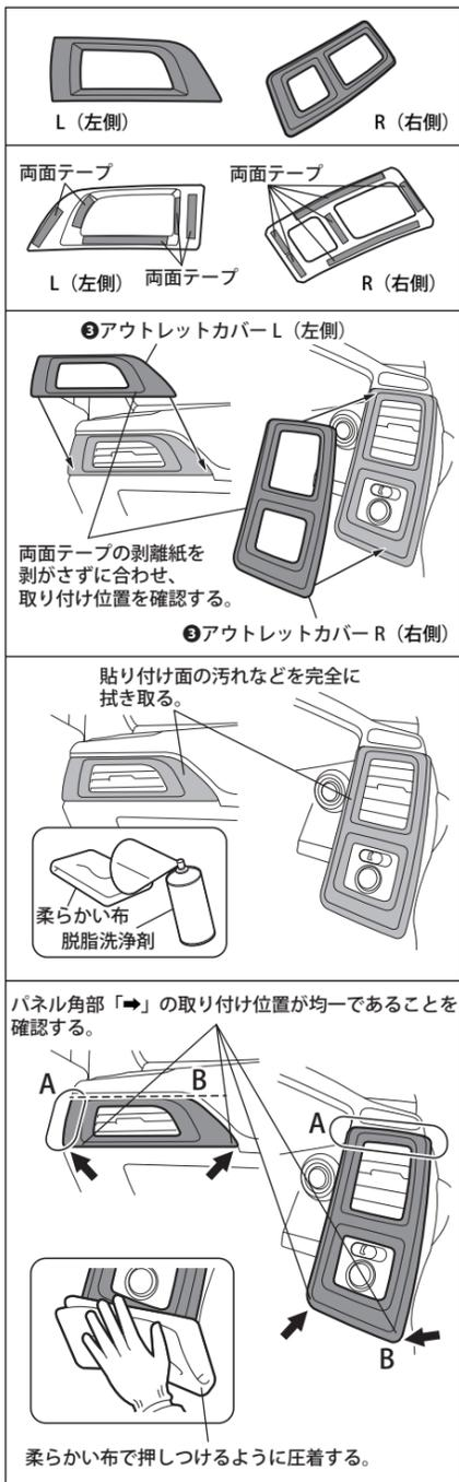
1. 両面テープの剥離紙を剥がさずに、アウトレットカバーを車両側に合わせ、取り付け位置を確認します。
